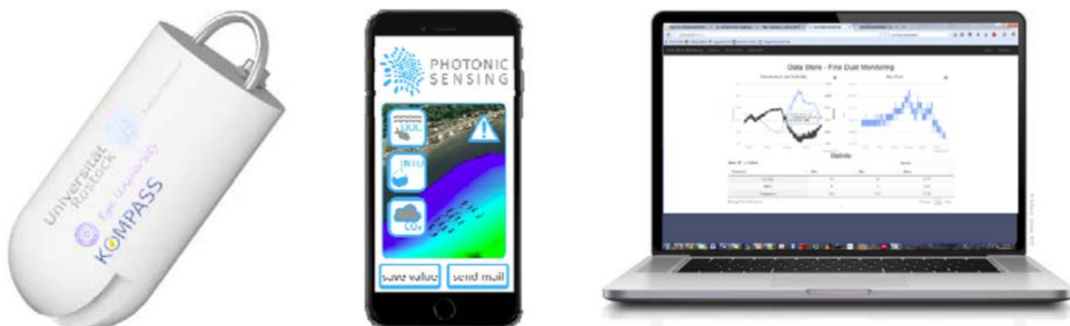
Bild 2: Konzept einer optischen Sensorsonde für Vor-Ort-Messungen in Gewässern und Benutzeroberfläche (Quelle: Universität Rostock)
